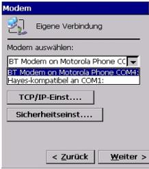
4. Wählen Sie im Feld **Modem** auswählen den Anschluss, der am MobileMapper CE zur Kommunikation mit dem Bluetooth-Modem des Mobiltelefons verwendet wird (also den zuvor zugewiesenen Anschluss, siehe Abbildung; das gewählte Modem sollte einen Namen ähnlich wie „BT Modem on <Name des Mobiltelefons> COMx“ tragen).
