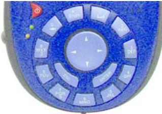
Der MobileMapper CE verwendet eine alphanumerische Tastatur ähnlich der eines Mobiltelefons. Über die Cursorstasten bewegen Sie den Cursor nach links, rechts, oben und unten.
