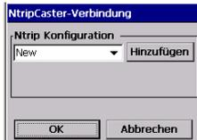
Jede Ntrip-Konfiguration enthält die Schlüsselinformationen, mit denen MobileMapper CE eine Verbindung zu einem bestimmten Ntrip-Caster aufbauen kann. Da Sie in MobileMapper CE mehrere Ntrip-Konfigurationen speichern können, können Sie den Ntrip-Caster schnell wechseln, ohne dass Sie die entsprechenden Verbindungsparameter jedes Mal neu eingeben müssen.
